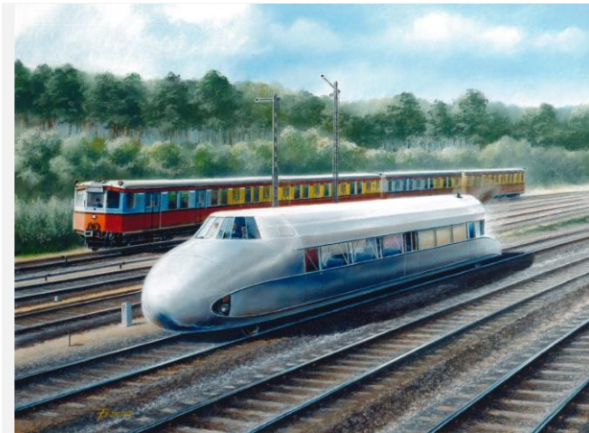
Abb. 2: Das Versuchsfahrzeug " Schienezepelin " von Franz Kruckenberg, nach der Rekordfahrt am 21.6.1931 ankommend in Berlin, zwischen den Fernbahnhöfen Berlin-Spandau und Berlin-Charlottenburg, nahe S-Bf Heerstraße. Nachdem Bedenken gegen den Propellerantrieb aus Sicherheits- und betrieblichen Gründen dieses Einrichtungsfahrzeugs nicht ausgeräumt werden konnten, wurde der Schienezepelin auf Dieselantrieb mit hydraulischer Kraftübertragung umgebaut und weitere Grundlagenforschung betrieben.
