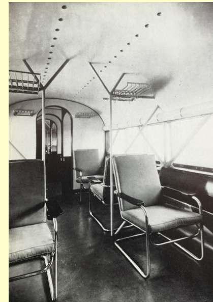
Das Innere des Flugbahnwagens – Stahlrohrsitze und schlichte Eleganz. Die Lochreihe in der Deckenverkleidung dient der Belüftung.
