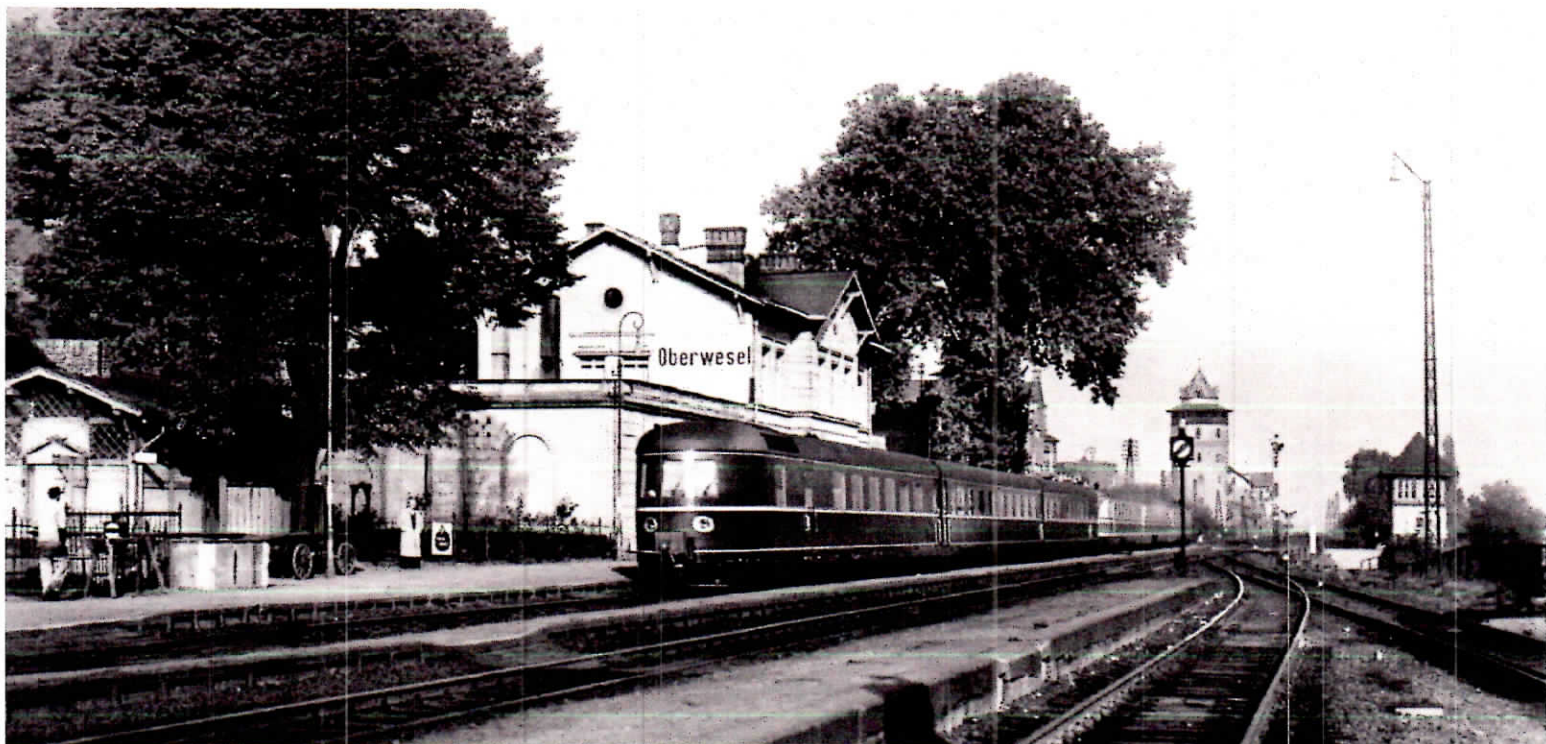
Oberwesel am Mittelrhein am 18. September 1952. Auch VT 07 502, der aus einem früheren SVT der Bauart Berlin hervorgegangen ist, fährt nun in der Rheinblitz-Gruppe mit. Hier ist er als Ft 8 Richtung Basel unterwegs, während VT 06 110 als Ft 28 nach gemeinsamer Fahrt bis Mannheim über Stuttgart nach München fährt.
